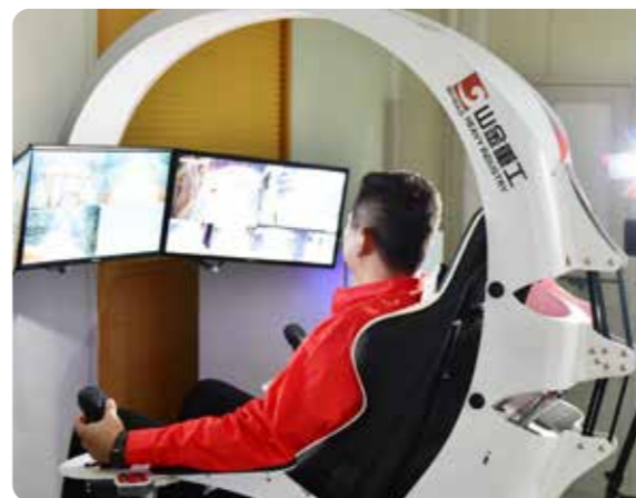
焦家金矿WiFi6 Mesh组网的远程操控系统
