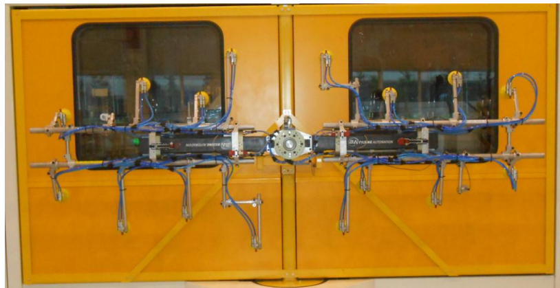
对中端拾器、端拾器更换支架参考图
