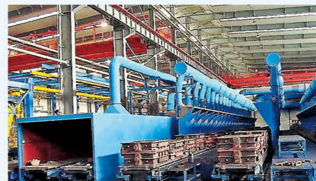
浇注除尘系统 Pouring dust-removal system
