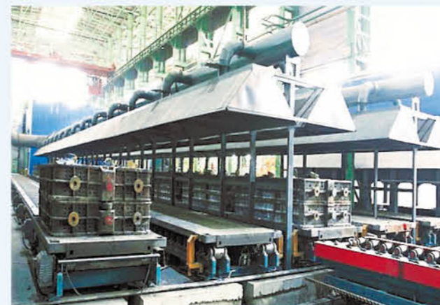
区域固定式除尘系统 Regional stationary type dust-removal system
