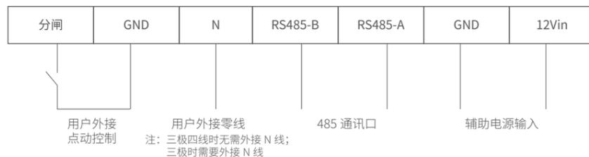
注意：1. 分闸端口只能接入无源控制信号，接入电源会导致产品损坏！
