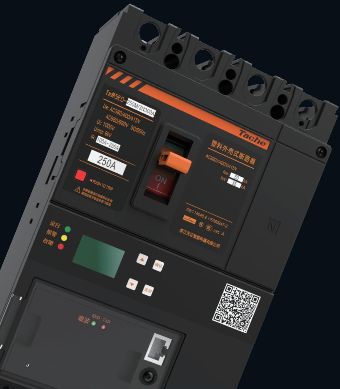
TeM5ED系列融合型塑料外壳式断路器适用于交流50/60Hz, 额定电压至415V, 额定电流至630A的低压电网线路中。是我司为响应智能配电网需求, 实现精益化台区管理, 开发的量测型塑料外壳式断路器。该产品集保护、计量、拓扑识别功能于一体, 具有RS485、宽带载波 (HPLC) 等多种通讯方式及通讯协议。可将线路故障、拓扑结构、运行监测等信息及时传递给智能配电网台区物联网系统, 实现台区计量异常监测、线损电能质量监测、及时运维的智能化管理。
