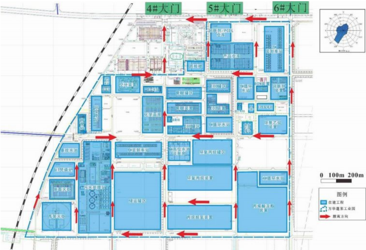
图 7.1-2 在建工程应急疏散范围图（西南风）
