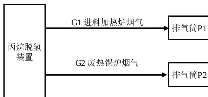
图 4.3-3 丙烷脱氢装置废气产生、收集、排放示意图
