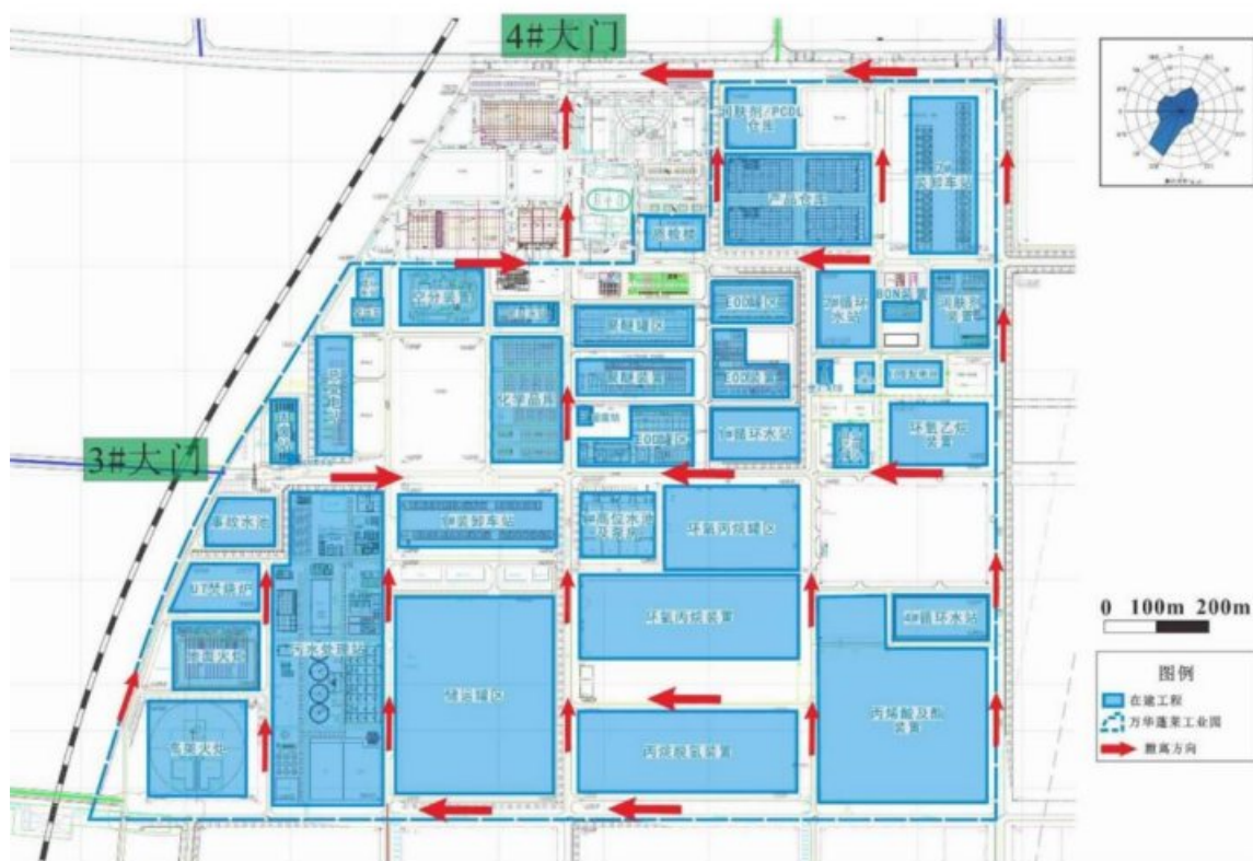
图 7.1-1 在建工程应急疏散范围图（西南风）
