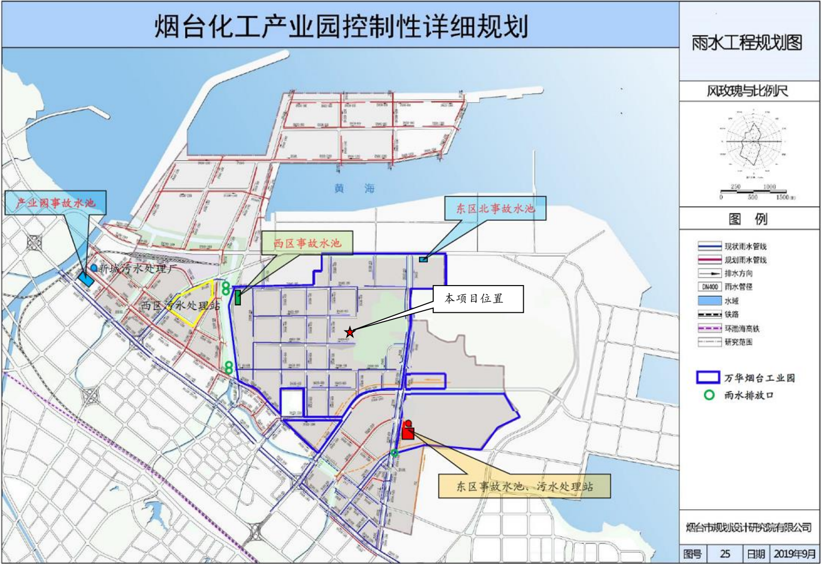
图 7.7-2 本项目事故水、雨水管网图
