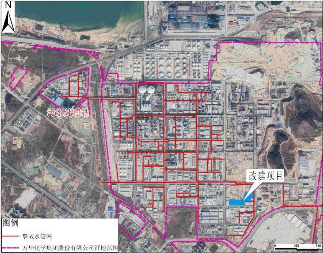
图 10.8-3 本项目事故水导排系统图
