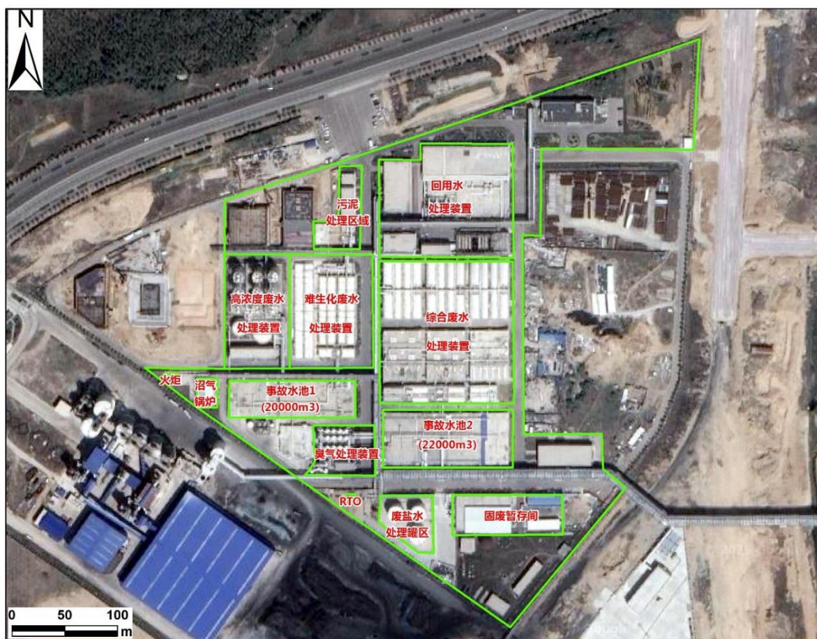
图 2.2-9(a) 万华环保科技西区污水处理站平面布置俯瞰示意图
