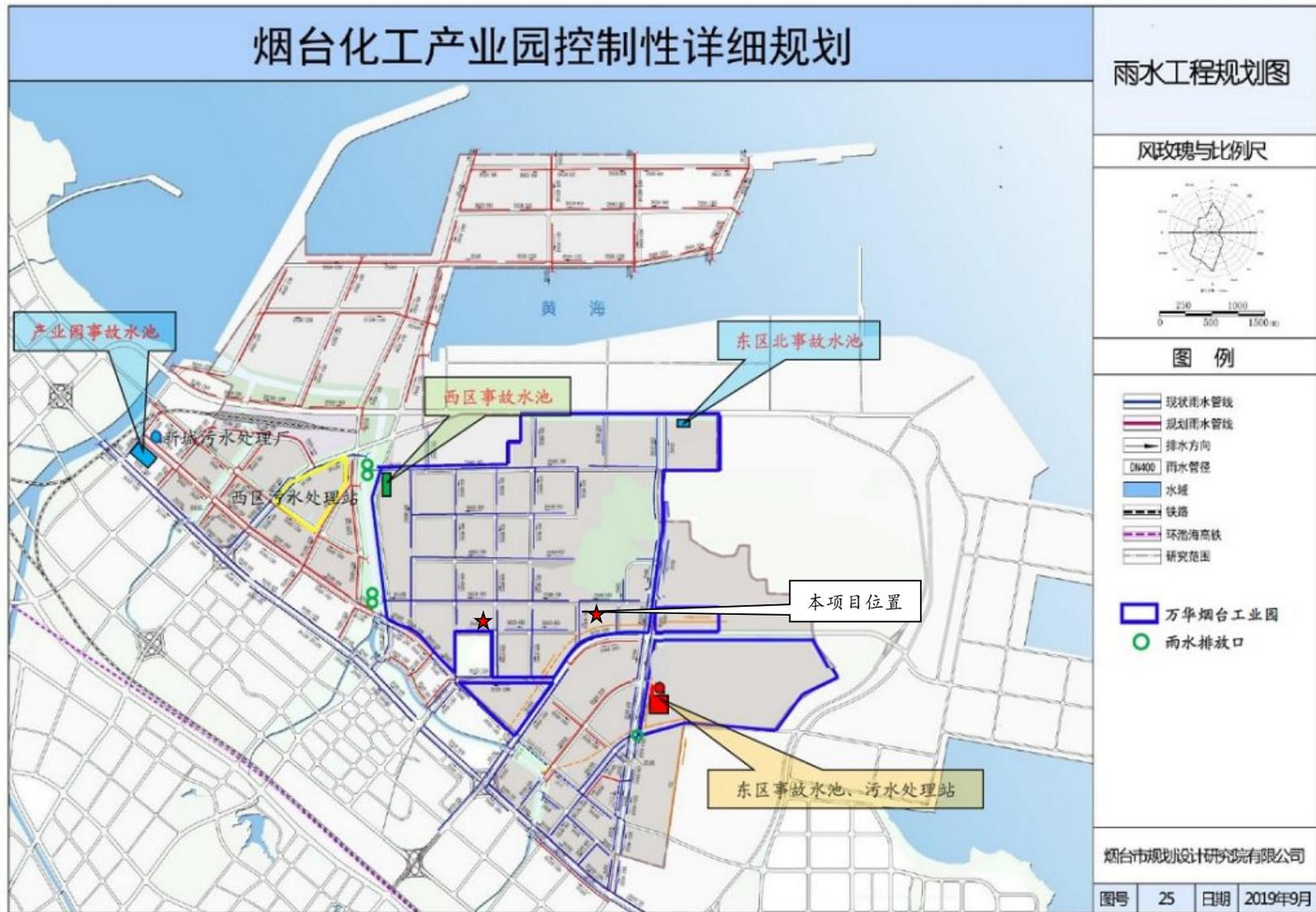
图 7.7-3 万华化学事故废水控制、封堵系统示意图
