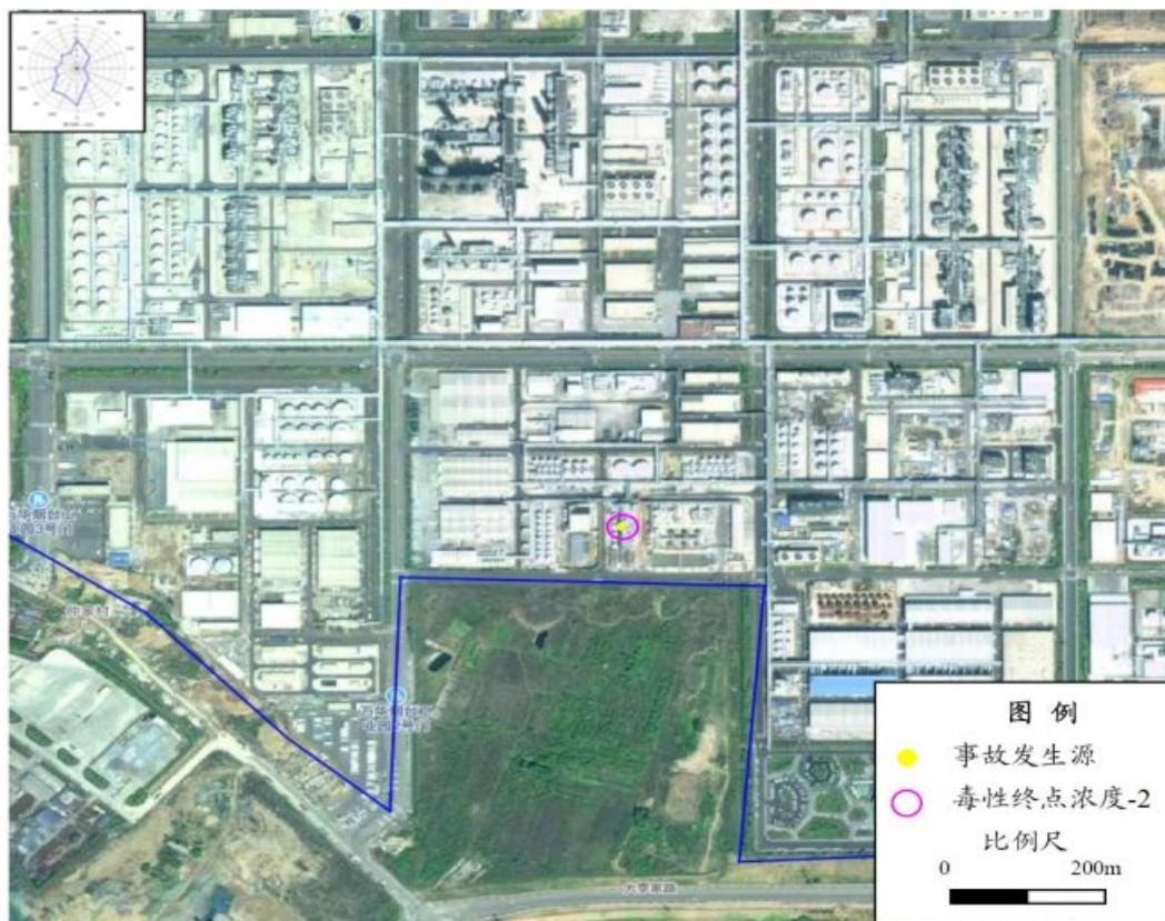
图 7.6-16 环氧乙烷管线泄漏事故预测后果范围图 (最常见气象条件)
