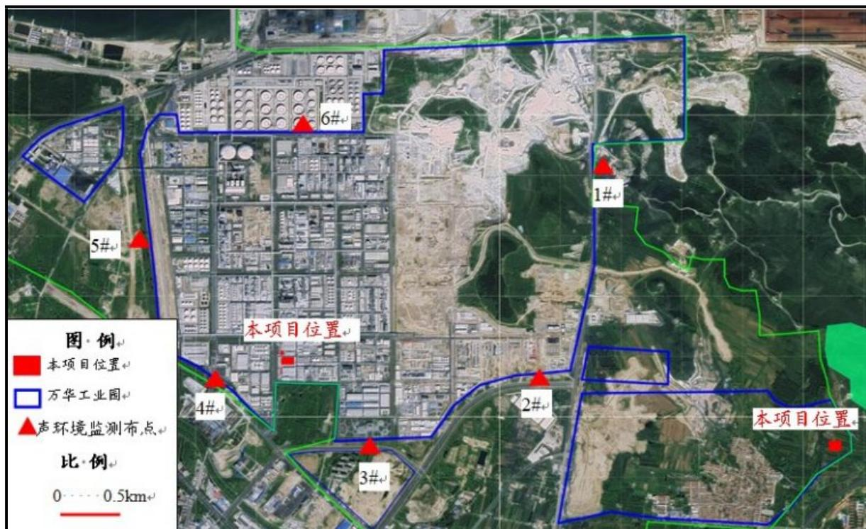
图 6.5-1 本项目装置区噪声源图及相对万华工业园区厂界预测点位置图
