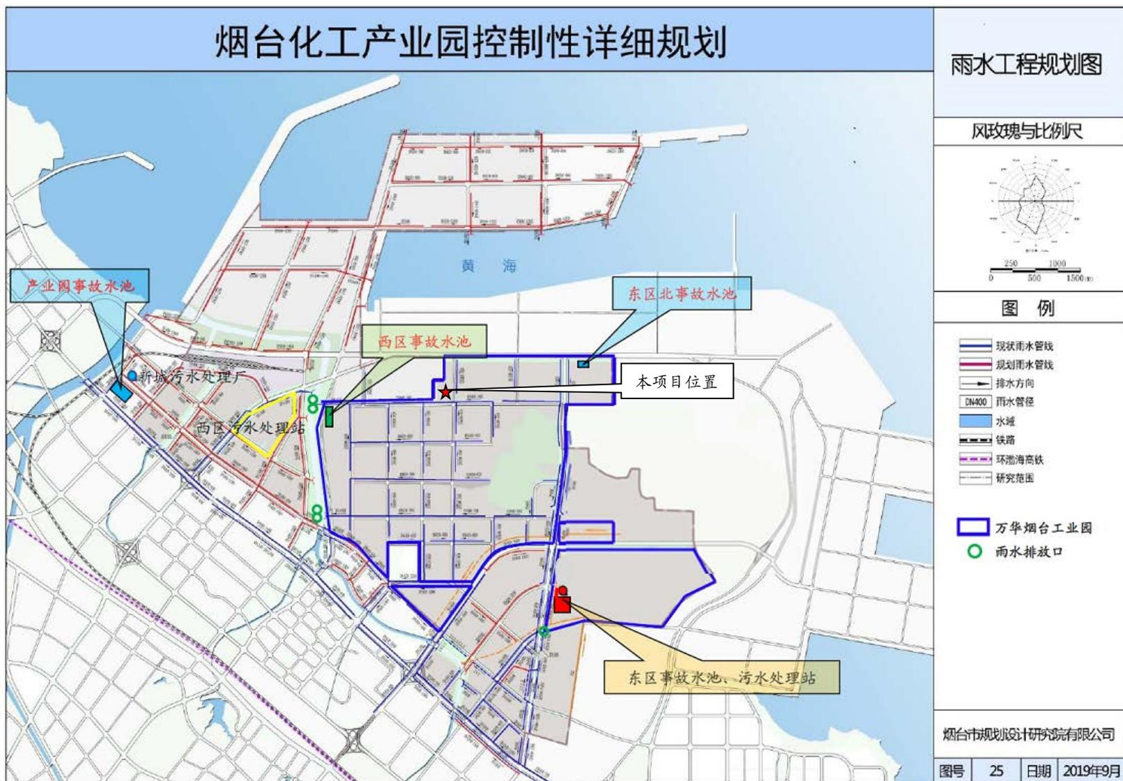
图 7.7-2 万华化学事故废水控制、封堵系统示意图
