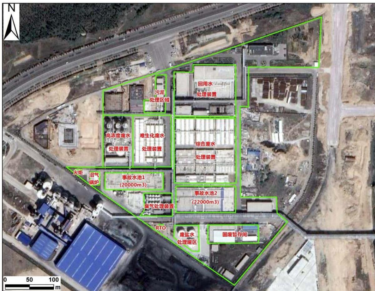
图 3.2-7 万华环保科技西区污水处理站平面布置俯瞰示意图
