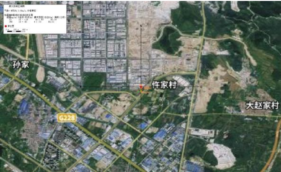
(红圈代表毒性终点浓度-1 范围，黄圈代表毒性终点浓度-2 范围) 图 7.9-4 盐酸储罐泄漏 HCl 扩散预测最大影响范围图 最常见气象条件下，盐酸储罐泄漏 HCl 扩散预测浓度未达到毒性终点浓度-1（150mg/m 3 ）的最大影响范围 40m，到达时间 0.17min，最大半宽为 4，最大半宽对应的 x 位置为 10m；达到毒性终点浓度-2（33mg/m 3 ）的最大影响范围 130m，到达时间 0.55min，最大半宽为 16，最大半宽对应的 x 位置为 50m。该范围内未涉及村庄、学校和医院等敏感点，事故对周围环境影响范围和程度较小。
