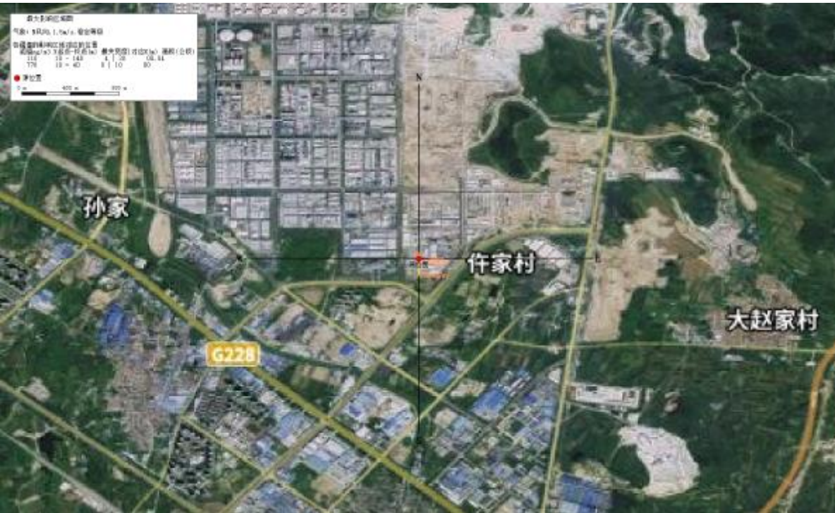
(红圈代表毒性终点浓度-1 范围，黄圈代表毒性终点浓度-2 范围) 图 7.9-6 氨水储罐泄漏 NH 3 扩散预测最大影响范围图 最不利气象条件下，氨水储罐泄漏 NH 3 扩散预测浓度达到毒性终点浓度-1（770mg/m 3 ）的最大影响范围 40m，到达时间 0.44min，最大半宽为 0，最大半宽对应的 x 位置为 10m；达到毒性终点浓度-2（1100mg/m 3 ）的最大影响范围 140m，到达时间 1.56min，最大半宽为 4，最大半宽对应的 x 位置为 30m。该范围内未涉及村庄、学校和医院等敏感点，事故对周围环境影响范围和程度较小。
