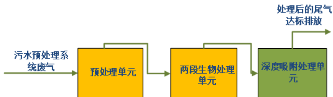
图 12.3-3 臭气处理系统方案三
