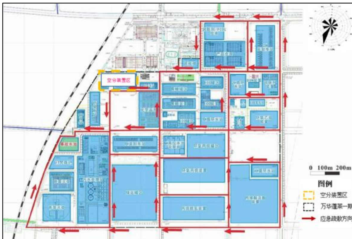
图 7.2-3 在建工程事故废水流向示意图
