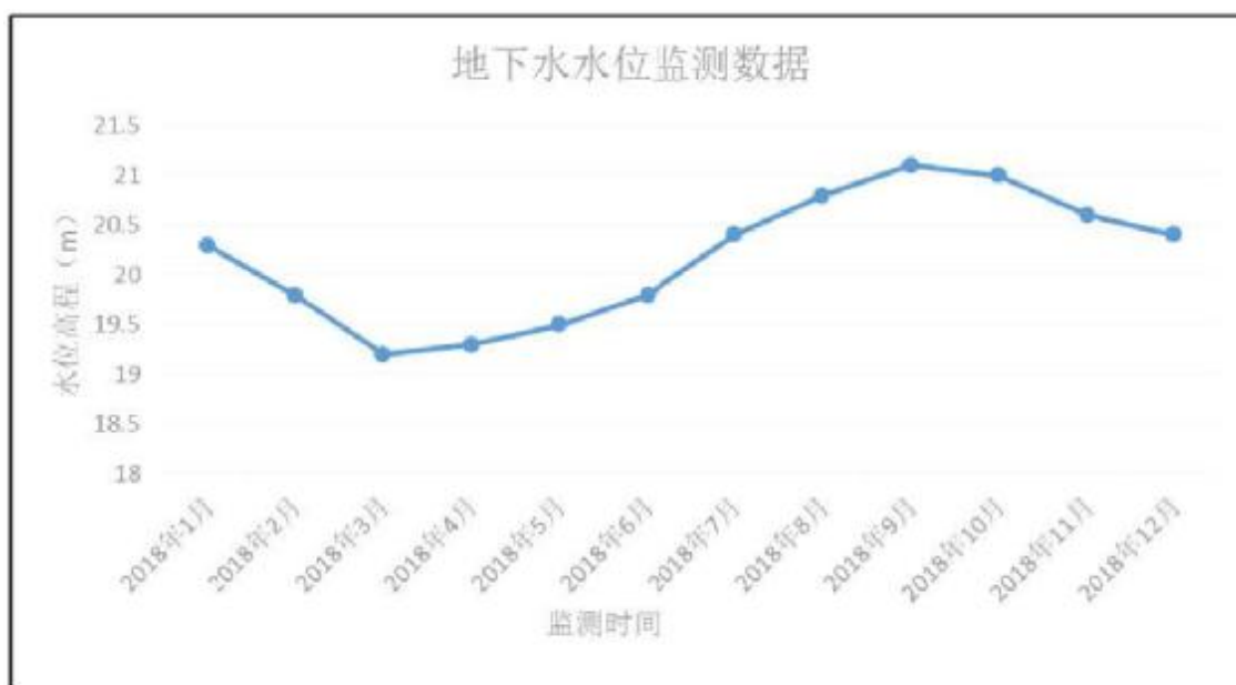
图 6.3-2 地下水水位长期监测数据
