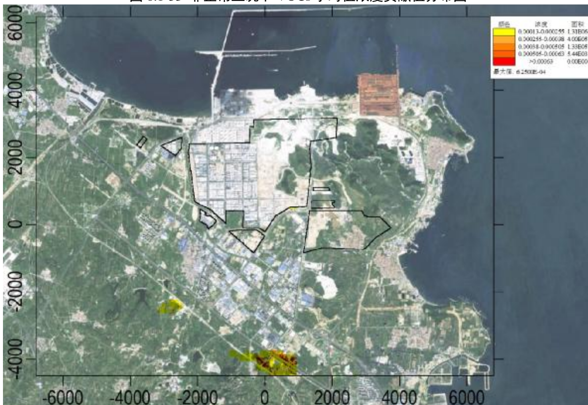
图 6.1-54 非正常工况下二氯甲烷小时值浓度贡献值分布图
