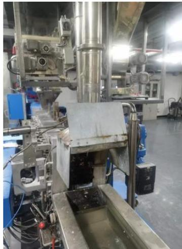
图 5 挤出机机头废气集气口
