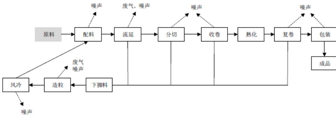
图 2.2-2 保鲜膜生产工艺流程及产污环节图
