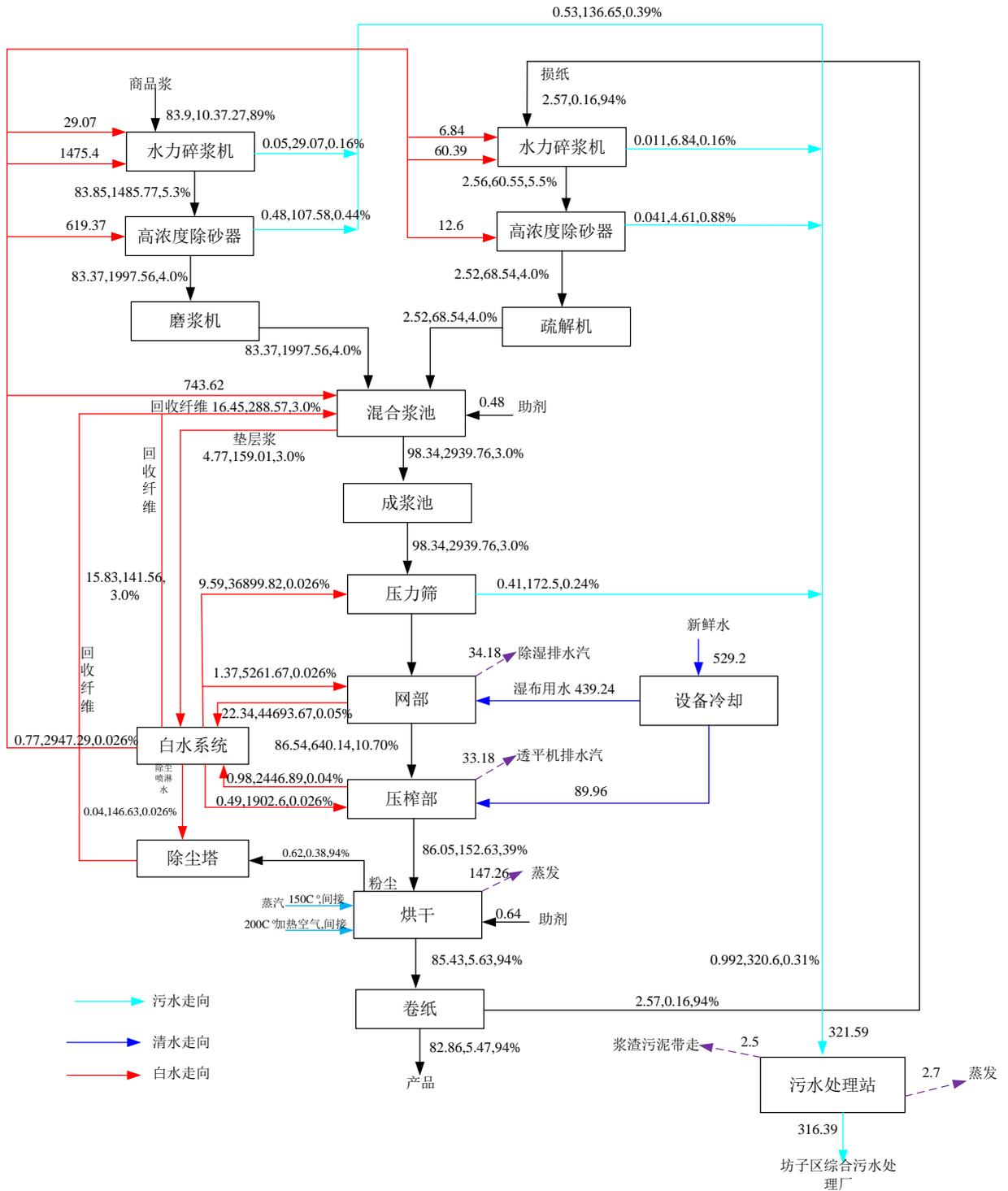
图2.3-2 拟建项目浆水平衡图 单位:t/d
