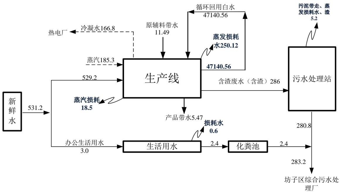
图 2.3-3 本项目水平衡图 单位: t/d
