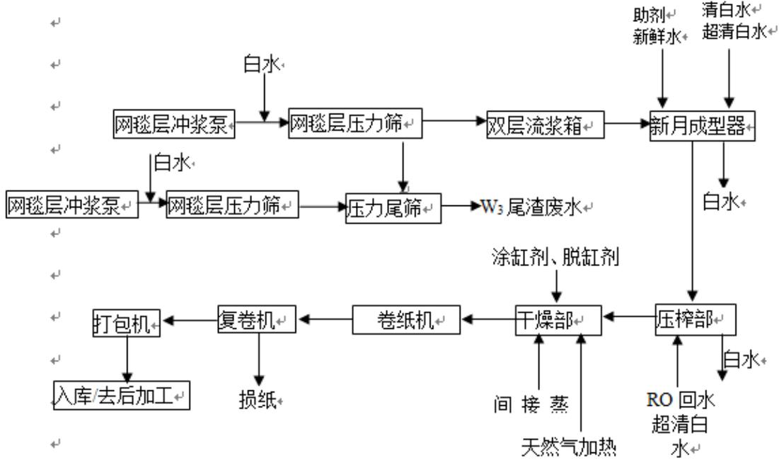
图 2.1-7 抄纸工段工艺流程和产污环节图
