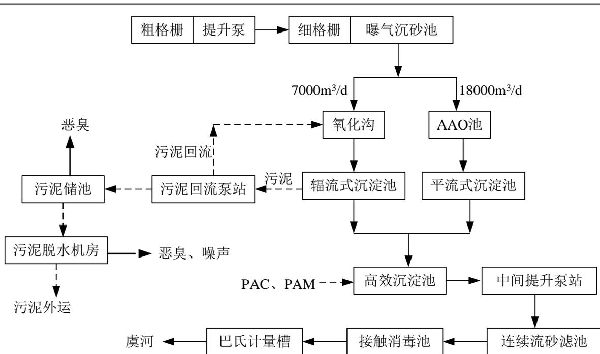
图 4.2-1 污水处理工艺流程图
