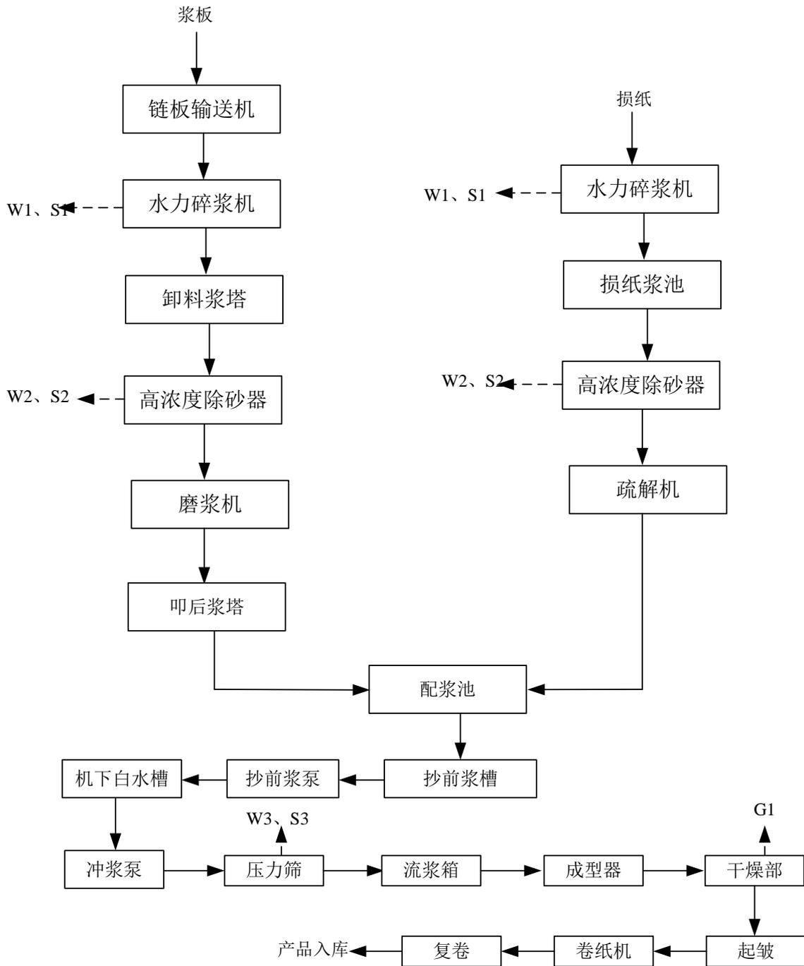
图 2.3-5 项目生产工艺流程及产污环节图
