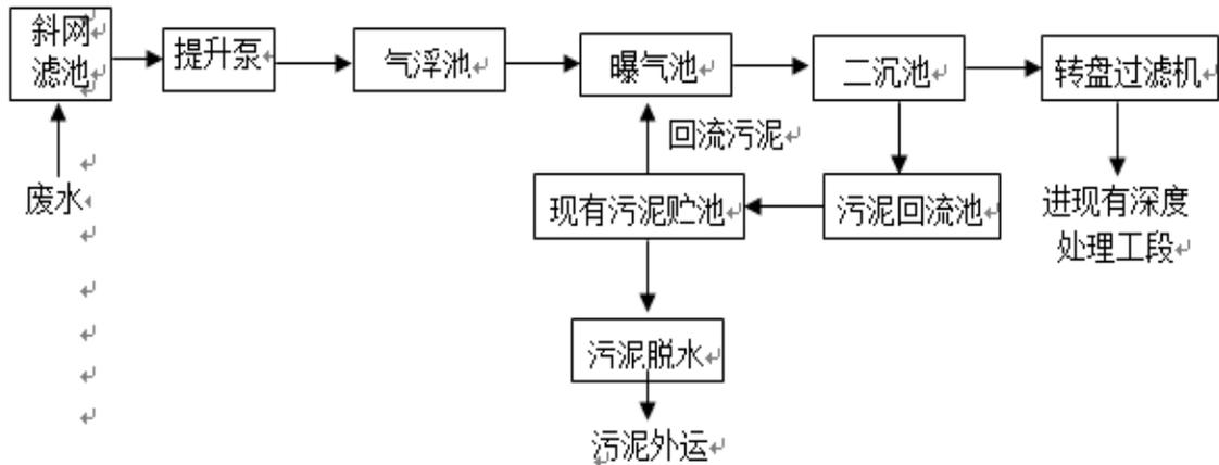
图 2.1-10 现有污水处理工艺流程图
