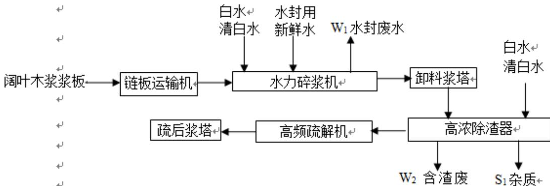
图 2.1-3 阔叶木浆制备线工艺流程及产污环节图
