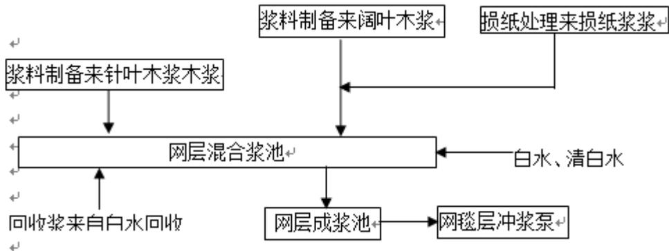
图 2.1-6 网层配浆线工艺流程图
