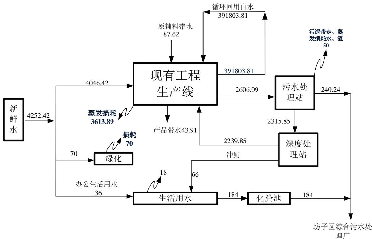
图 2.1-1 现有工程水平衡图 单位: t/d
