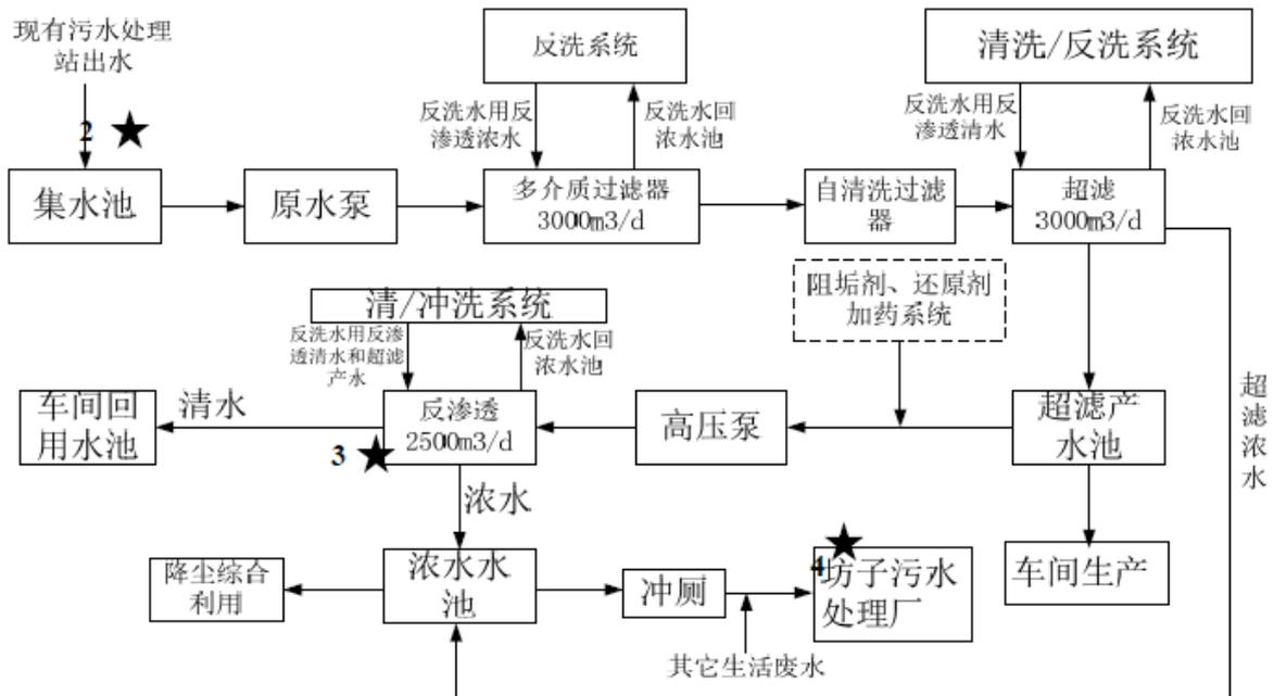
图 2.1-11 深度处理工艺流程图
