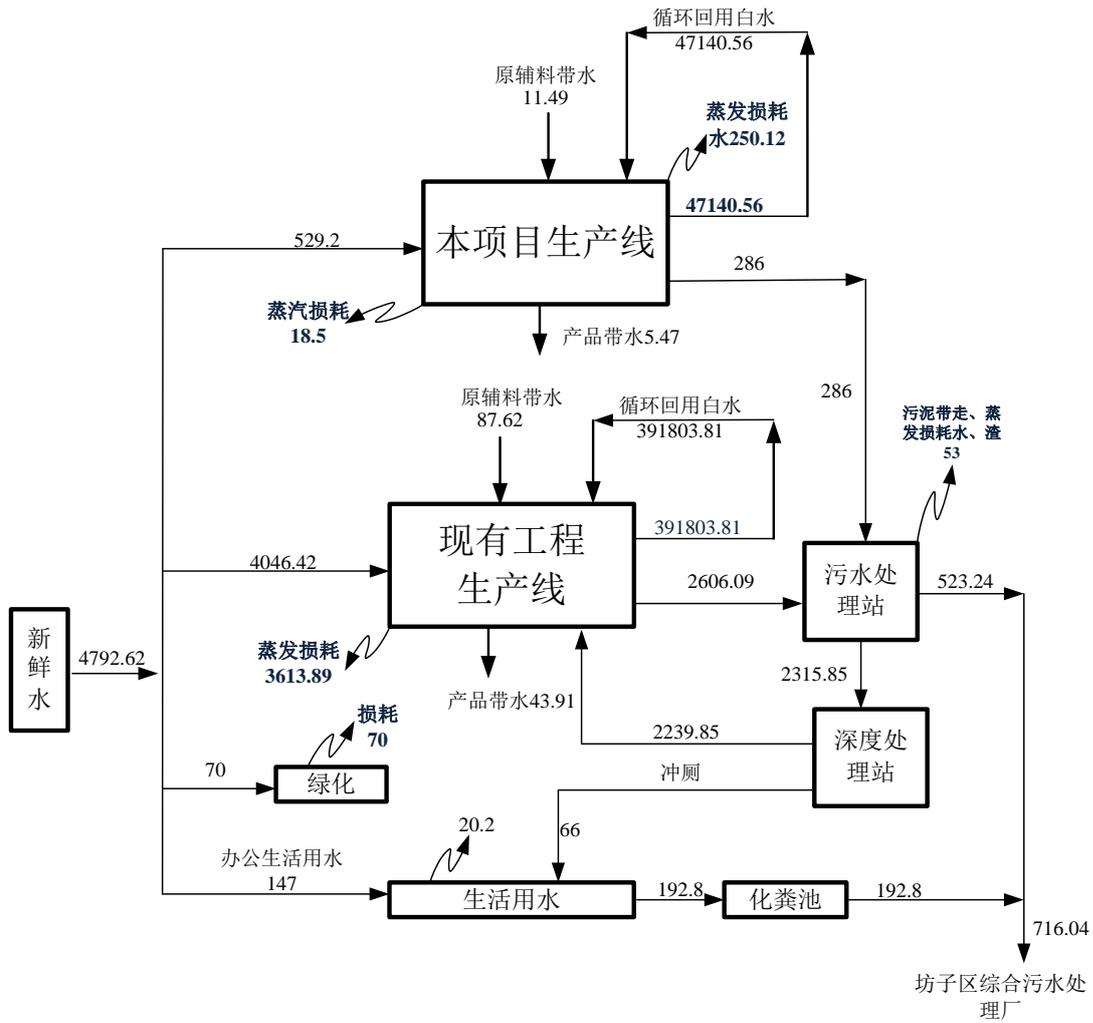
图 2.3-4 全厂水平衡图 单位: t/d
