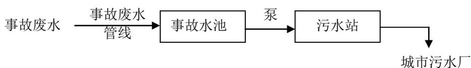
图 4.3-1 事故废水收集流程图
