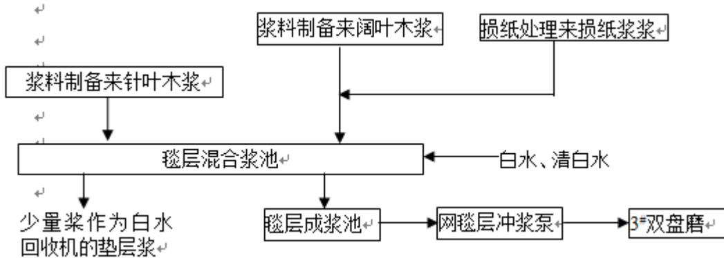
图 2.1-5 毯层配浆线工艺流程图
