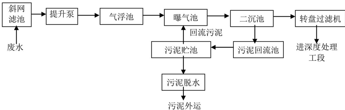
图 2.3-6 污水处理站工艺流程图
