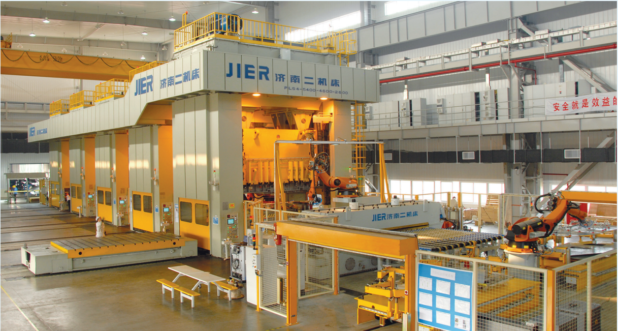
机器人冲压生产线
