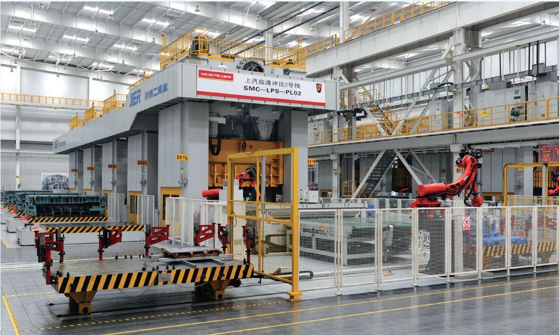
机器人冲压生产线
